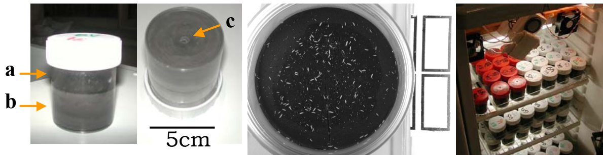
Figure 12 Boîtes d'élevage de type "Tully". À gauche, présentation d'une boîte d'élevage standard : a, volume dans lequel vivent les collemboles; b, épaisse couche de plâtre noircie à l'encre de chine; c, trou au fond de la boîte permettant sa réhumidification. Au centre, aperçu d'une boîte vue de dessus, où prospère une population de collemboles. À droite, disposition des boîtes dans un incubateur (les ventilateurs permettent un brassage de l'air et une grande stabilité de la température).
